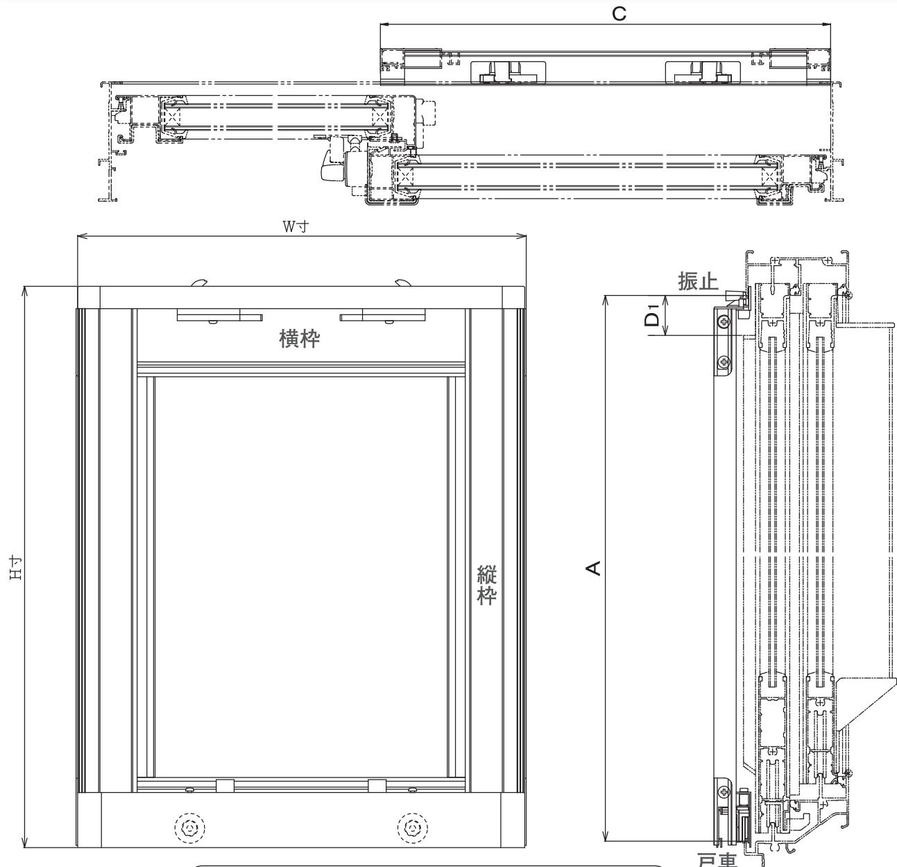
A: 網戸レール内のり+10mmが網戸出来(仕上り)寸法。
